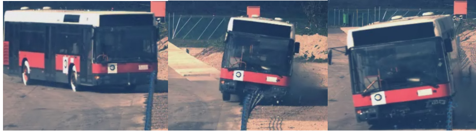
Figure 10 : Aperçu de la déformation dynamique d'une glissière à câble haute tension avec un autobus (18)
