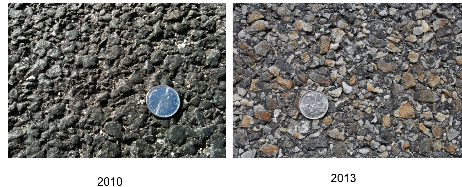
FIGURE 9 – Change in SMA Section (D) Surface Macro-texture
