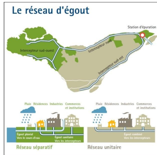
Figure 22 – Réseau d'égout de l'île de Montréal 30
