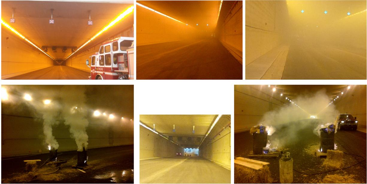
FIGURE 12 – PHOTOS OF TUNNEL SMOKE TESTING
