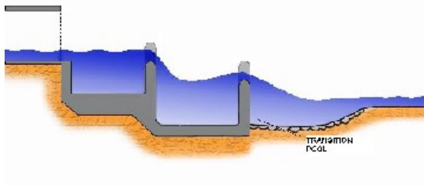
FIGURE 2 – TYPICAL PLUNGE POOL INSTALLATIONS
