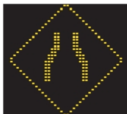
PMV-T-D-210-1 Chaussée rétrécie
