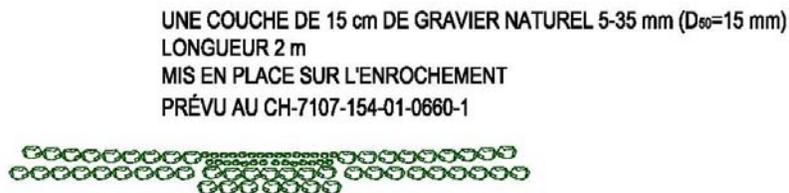
Figure 4 Vue longitudinale de la surface de gravier de frayère présentée à la figure 3 (DS-181-106 de Pro Faune, dossier n° 154010660).
